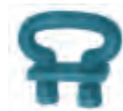
Becherbügel für Rundgliederkette nach DIN 745 aus C 15 und C 45 (auch gehärtet) Chain bracket to DIN 745 in C 15 and C 45 (also hardened)
